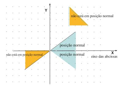
Um ângulo está em **posição normal** relativamente a um sistema de eixos, quando o seu vértice coincide com a origem do sistema de eixos. O seu lado origem coincide com o semieixo positivo Ox.
